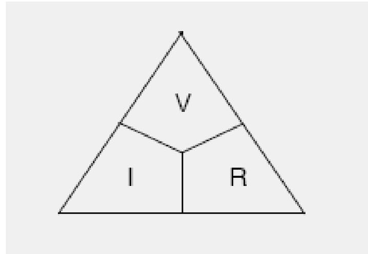
I = carga eléctrica que pasa a través de una sección o conductor en la unidad de tiempo.
